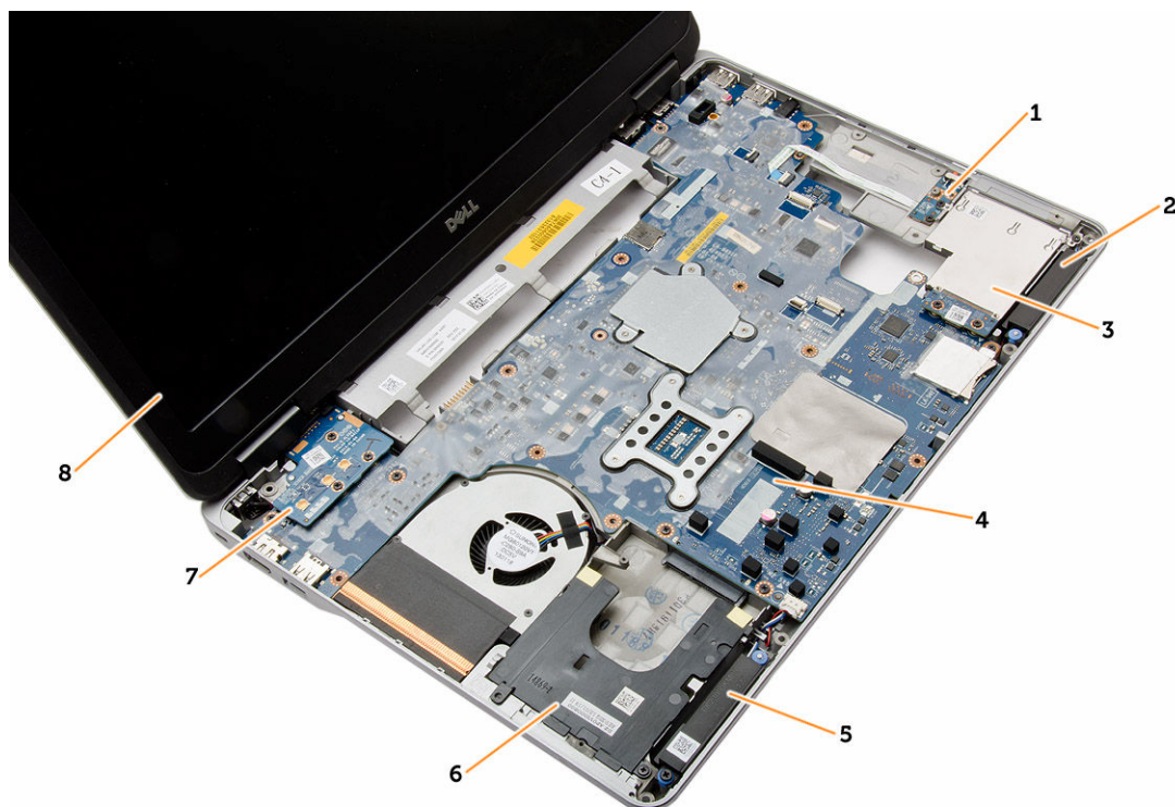
Ilustración 2. Vista superior: se ha extraído el ensamblaje del teclado y del reposamanos
